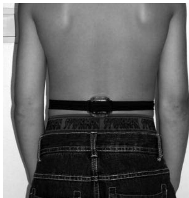
Figur 1. Exempel på accelerometer och hur den fästs på kroppen.
